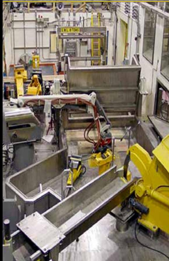
**Démolition** d'une cellule chaude derrière une vitre acrylique. Brokk 330 équipé d'un SB 450.
