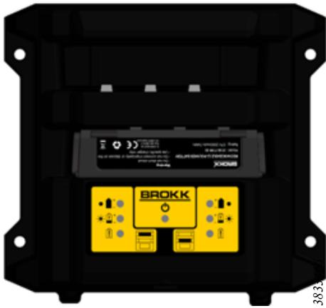
Figure 88. Chargeur pour la batterie de l'unité de commande
