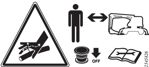
Figure 39. Risque de blessure de l'opérateur. Rester à distance. Faites reposer le système de bras sur le sol. Mettez le moteur hors tension. Lisez le manuel
