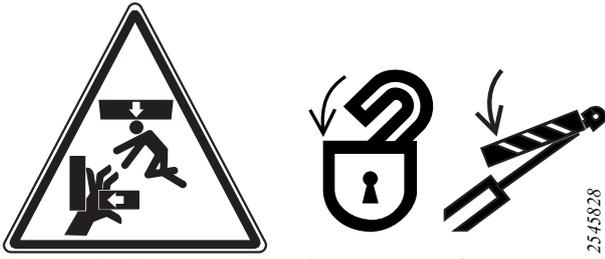
Figure 40. Fixez toujours mécaniquement les composants mobiles avant de déconnecter les articulations vissées ou les flexibles hydrauliques
