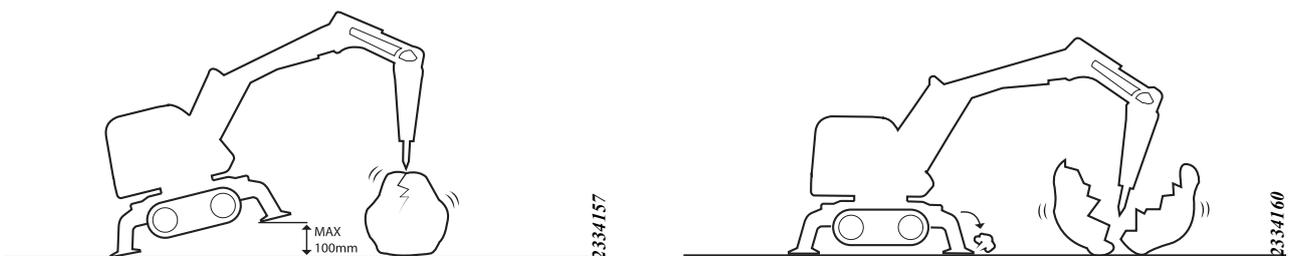
Figure 72. Ne pas exercer de pression excessive avec le brise-béton. Percer des éléments avec les stabilisateurs levés peut endommager leurs vérins ainsi que d'autres éléments de l'engin. Lever les stabilisateurs à max. 100 mm de la surface.
