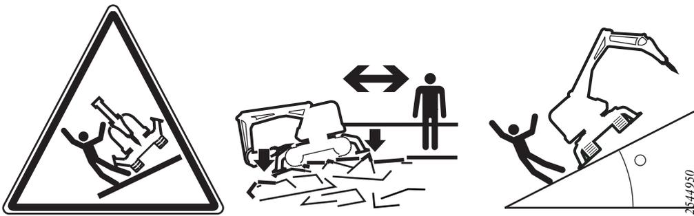
Figure 25. Risque de compression ou d'écrasement. Les stabilisateurs doivent être déployés pendant le travail. Arrimer l'engin. Rester à distance
