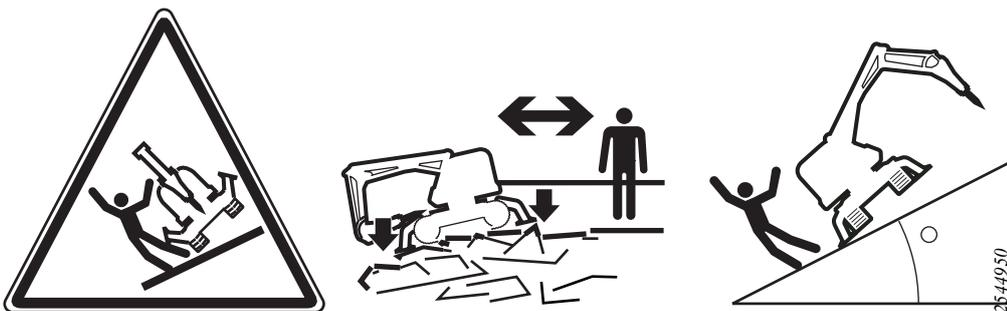
Figure 28. Risque de compression ou d'écrasement. Les stabilisateurs doivent être déployés pendant le travail. Arrimer l'engin. Rester à distance
