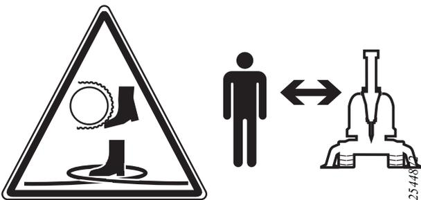
Figure 66. Risque d'écrasement ou d'enchevêtrement. Rester à distance
