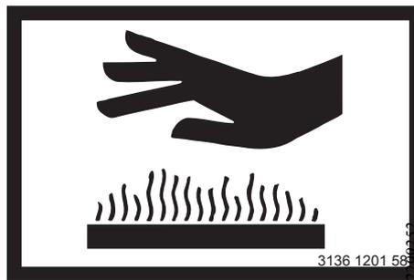
Figure 53. Avertissement concernant les surfaces très chaudes, risque de brûlure sérieuse en cas de contact
