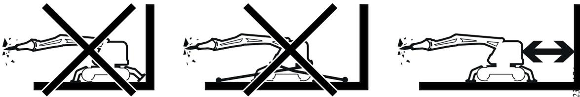
Figure 75. Ne pas appuyer les stabilisateurs contre des murs verticaux. Ne pas ancrer l'engin à la surface. Toujours ménager un dégagement entre l'engin, les stabilisateurs et les murs alentour.
