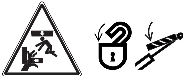
*Assurer toujours les composants mobiles à l'aide d'un dispositif mécanique avant de débrancher des raccords à visser ou des tuyaux hydrauliques*
