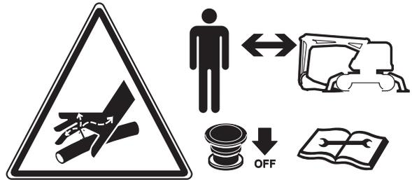
*Mettre le système hydraulique hors pression*
