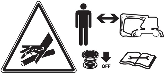
*Risque de blessure de l'opérateur. Rester à distance. Faire reposer le système de bras au sol. Mettre le moteur à l'arrêt. Lire le manuel*
